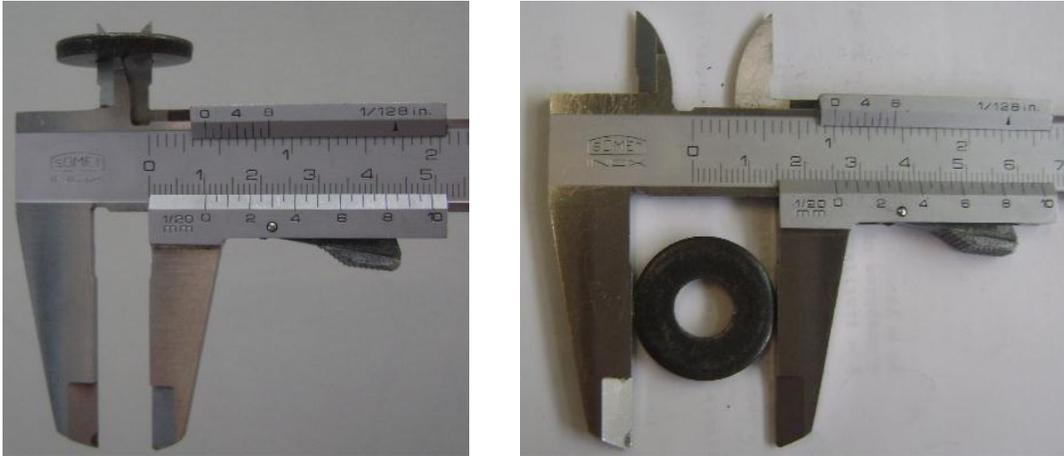
**Figura 4. Imágenes que muestran cómo utilizar el calibrador para mediciones internas y externas de una pieza**
