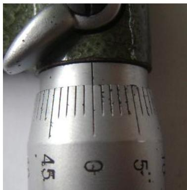
**Figura 8. Ajuste del cero para el tornillo micrométrico.**
