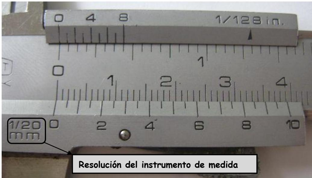
**Figura 2. Resolución del calibrador.**
