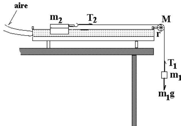
Las masas  $m_1$ ,  $m_2$ , y la masa de la polea  $M$  con su radio  $r$  son conocidas. La cuerda se asume como inextensible. Se desprecia la fricción en la polea y el rozamiento entre la masa  $m_2$  y el carril de aire.
