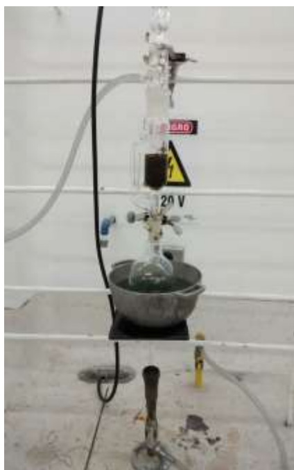
Fig. 1. Extracción del extracto etéreo y alcohólico de la Galinsoga parviflora por medio del método soxhlet.
