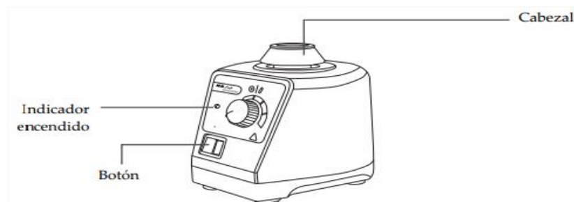
Figura 39. Partes del Agitador Vórtex. [2]
