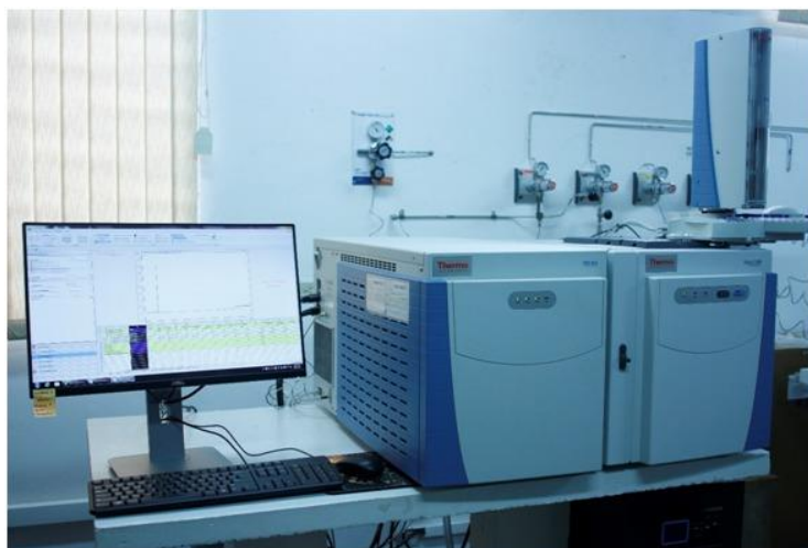
Figura 23. Cromatógrafo de gases acoplado a espectrómetro de masas triple cuadrupolo (GC-MS/MS). Fuente: Fuente propia
