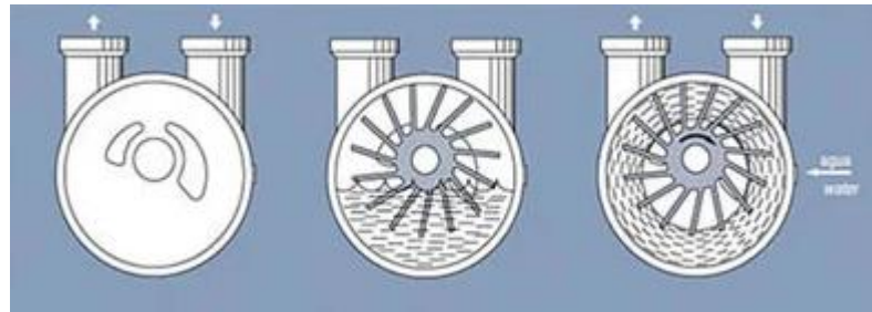
Figura 41. Funcionamiento de la bomba de vacío. [2]
