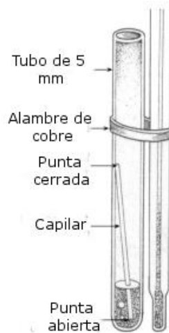
Figura 2. Detalle método de Siwoloboff para punto de ebullición. [2]
