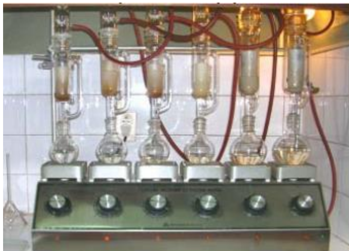
Figura 20. Calentador múltiple con seis equipos de extracción. [5]
