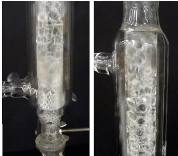
Figura 17. Inundación de una columna de fraccionamiento. [4]
