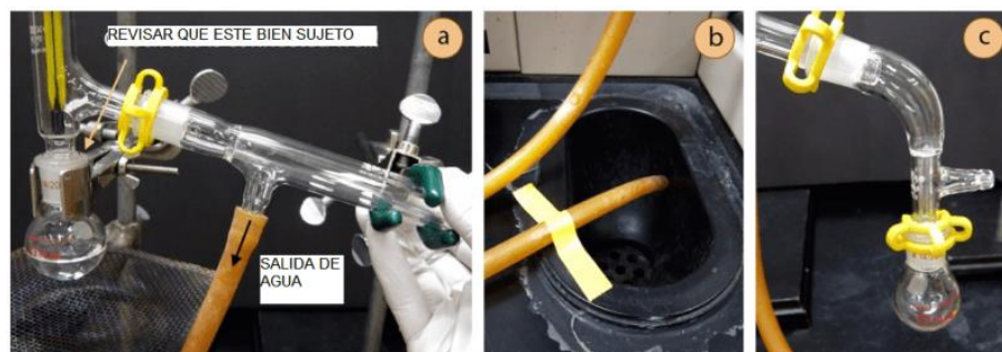
Figura 9. a) Conexión del condensador al adaptador de tres vías (con la flecha apuntando a la junta que necesita ser muy segura por razones de seguridad), b) Fijación de las mangueras de agua al fregadero con cinta de laboratorio, c) Fijación del adaptador de vacío y del matraz receptor. [3]
