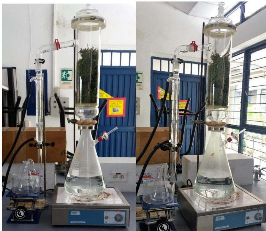
Figura 22. Montaje de extracción por arrastre con vapor de la Maestría en Ciencias Químicas. Fuente propia.
