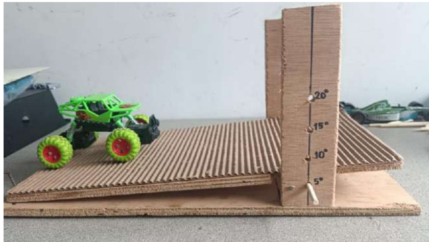
Figura 6. Superficie de cartón e inclinación de la rampa a 5 °
