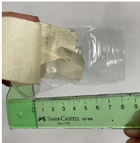
Figura 8. Cambios en la longitud del vaso
