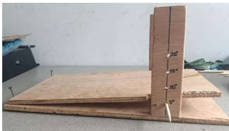
Figura 1. Superficie de madera e inclinación de la rampa
