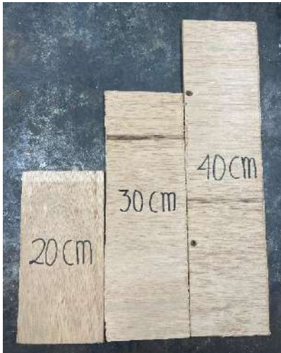
Figura 2. Columnas de madera
