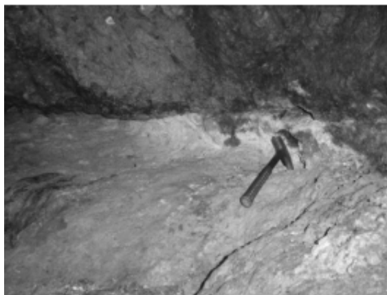
Foto 1. La veta de cuarzo alberga los minerales de cobre (calcopirita).
