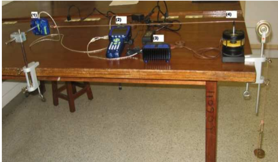
Figura 3.6: Montaje experimental: (1) Sensor de fuerza, (2) Xplorer GLX, (3) Amplificador de potencia, (4) Vibrador mecánico
