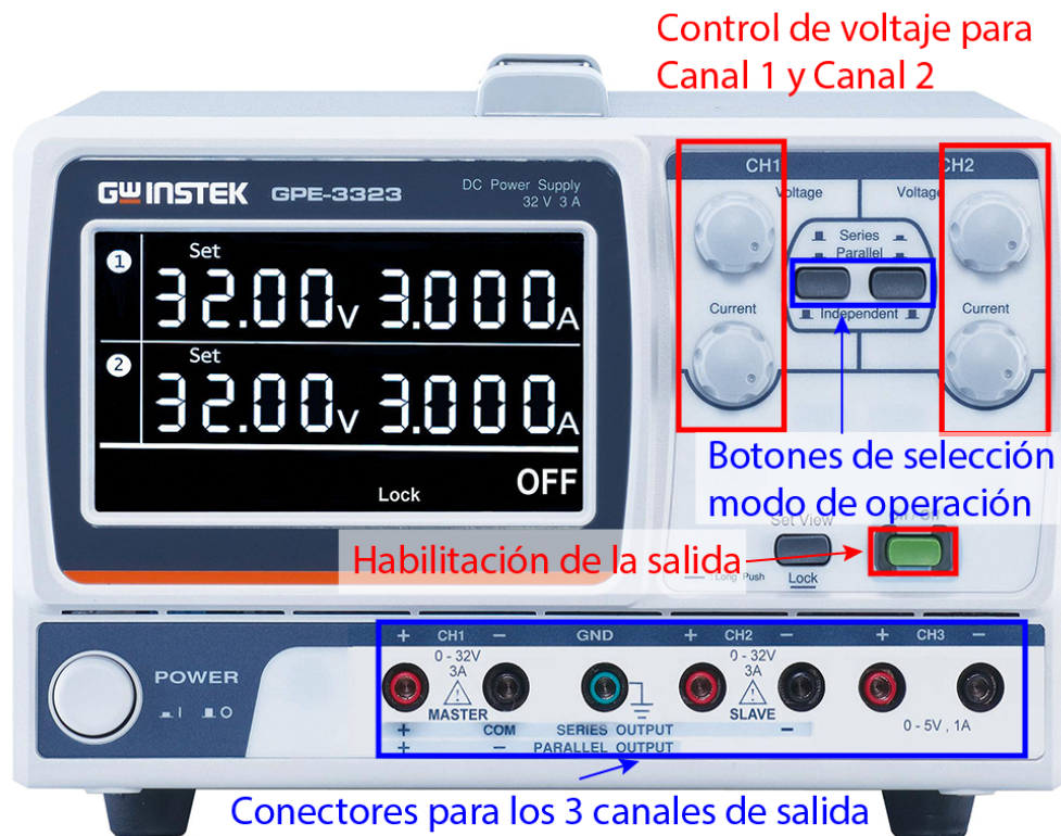
Figura 3: Fuente digital de voltaje
